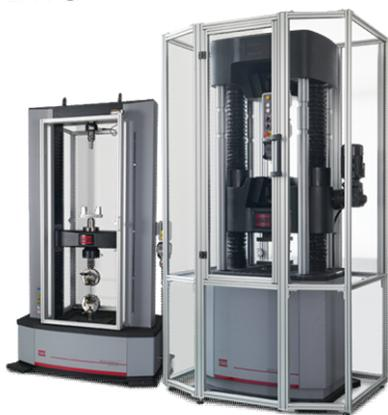
Macchina di prova idraulica
